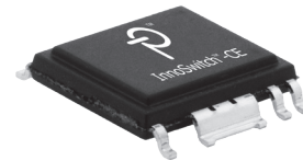
圖 2. 高沿面、符合安全要求的 eSOP-R16B 封裝
