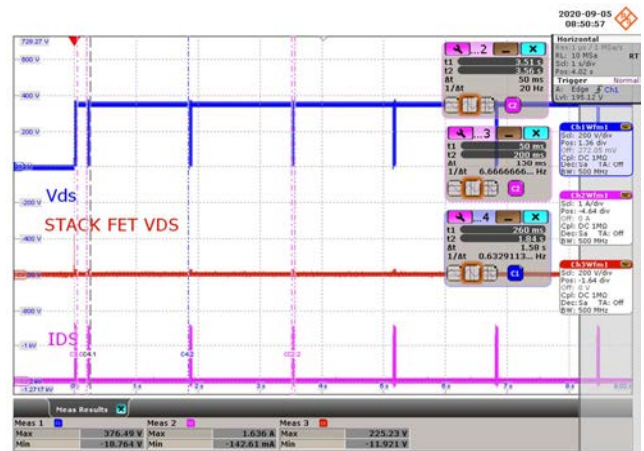
Figure 66 – 360 VDC Input. Output Short. CH1: IC V_{DS} , 200 V / div., 1 s / div. CH2: I_{DS} , 1 A / div., 1 s / div. CH3: FET V_{DS} , 200 V / div., 1 s / div. IC V_{DS(MAX)} = 376.49 V., I_{DS(MAX)} = 1.63 A. Stack FET V_{DS(MAX)} = 225.53 V.
