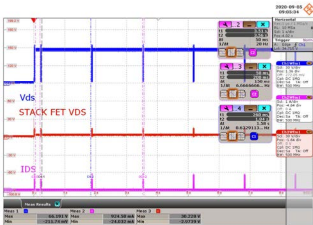
Figure 65 – 60 VDC Input. Output Short. CH1: IC V_{DS} , 30 V / div., 1 s / div. CH2: I_{DS} , 1 A / div., 1 s / div. CH3: FET V_{DS} , 30 V / div., 1 s / div. IC V_{DS(MAX)} = 66.19 V., I_{DS(MAX)} = 924.58 mA. Stack FET V_{DS(MAX)} = 30.22 V.
