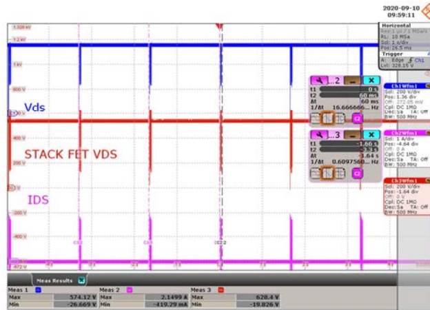
Figure 69 – 1100 VDC Input. Output Short. CH1: IC V_{DS} , 200 V / div., 1 s / div. Ch2: I_{DS} , 1 A / div., 1 s / div. CH3: FET V_{DS} , 200 V / div., 1 s / div. I_{C V_{DS(MAX)}} = 574.12 \text{ V} , I_{DS(MAX)} = 2.14 \text{ A} . Stack FET V_{DS(MAX)} = 628.4 \text{ V} .
